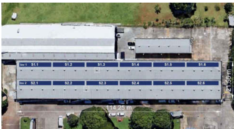
Figura 4 – Disposição dos módulos fotovoltaicos no telhado.
