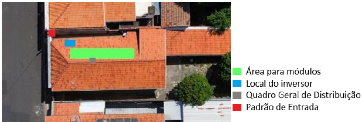
Figura 9: Disposição dos módulos e inversor.
