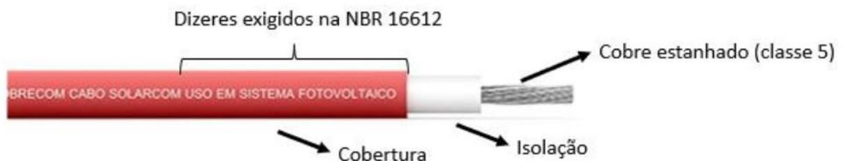
Figura 9 - Exemplo de cabo CC para aplicações fotovoltaicas de acordo com a NBR 16690
