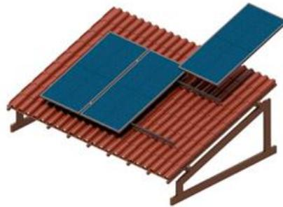
Figura 11 – Esquema de montagem da estrutura de fixação de MFV em telhado de cerâmica com estrutura em madeira
