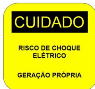
Figura 18: Detalhamento da placa indicativa a ser instalada de forma visível no ramal de entrada.
