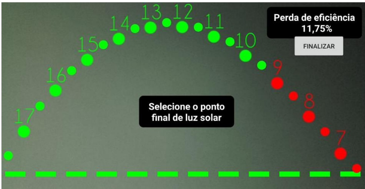
Figura 5: Perdas geradas por sombreamento no intervalo de tempo de 6:00 às 9:00 horas.
