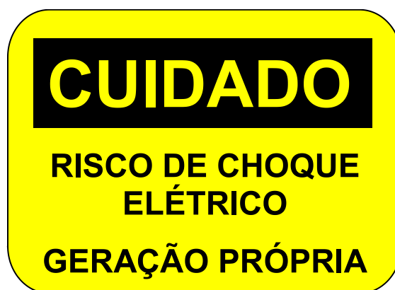
Figura 25: Placa de advertência que deve ser instalada na usina FV, próxima à caixa de medição (medidas 20 x 15 cm).
