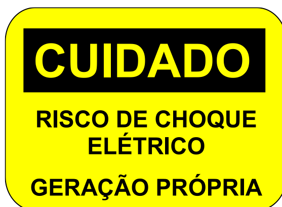
Figura 20: Placa de advertência que deve ser instalada na usina FV, próxima à caixa de medição (medidas 20 x 15 cm).
