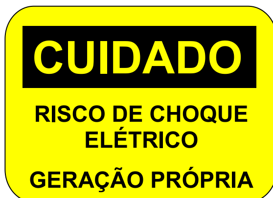
Figura 23: Placa de advertência que deve ser instalada na usina FV, próxima à caixa de medição (medidas 20 x 15 cm).
