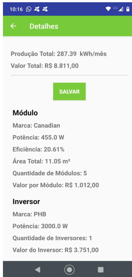
Figura 8: EStimate – Custos estimado dos equipamentos e configuração do projeto.
