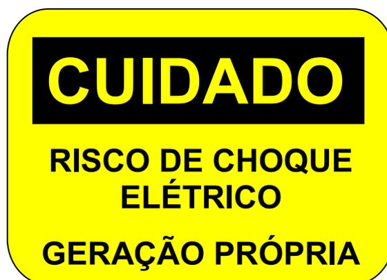
Figura 17: Placa de advertência que deve ser instalada na usina FV, próxima à caixa de medição (medidas 20 x 15 cm).
