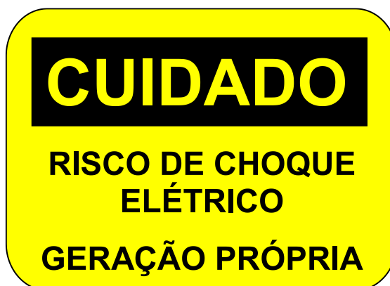
Figura 21: Placa de advertência que deve ser instalada na usina FV, próxima à caixa de medição (medidas 20 x 15 cm).
