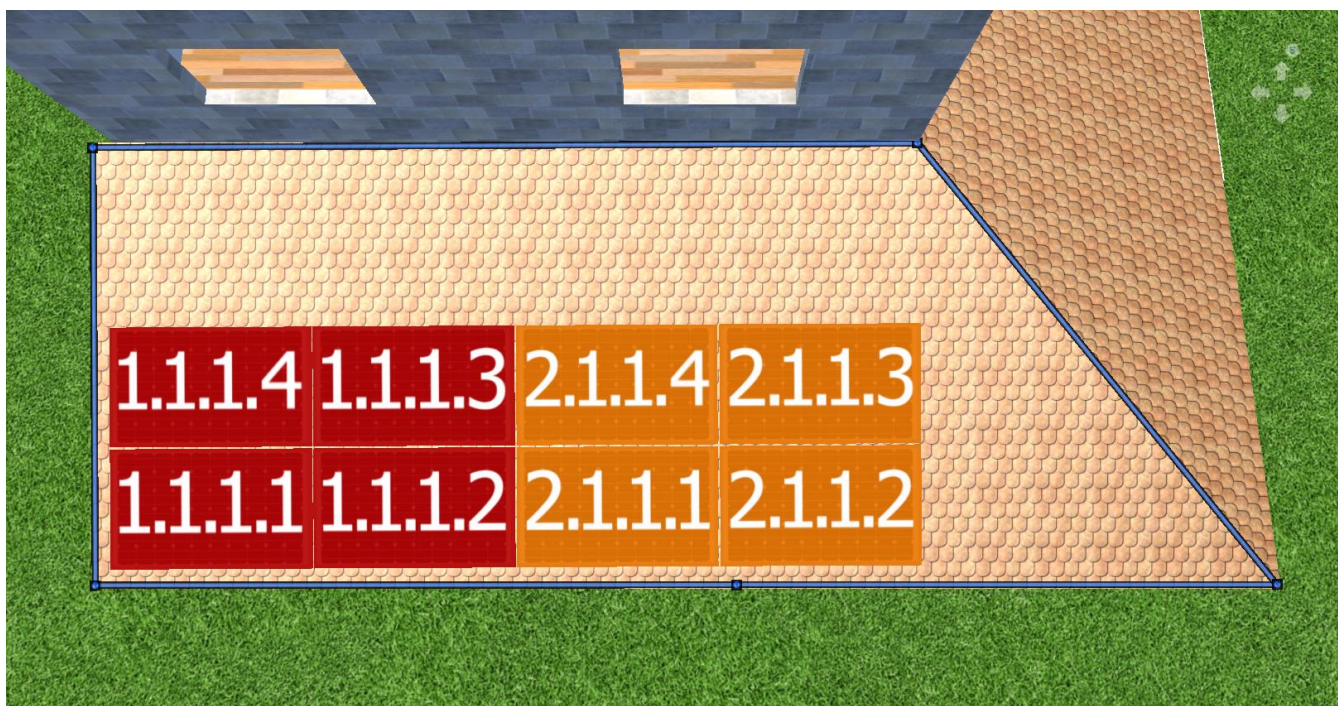
Figura 9: Disposição dos módulos das strings por inversor.
