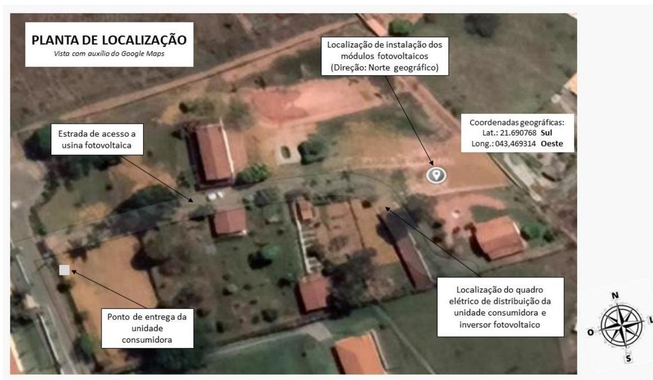
Figura 20: Vista real da planta de localização da unidade geradora fotovoltaica.
