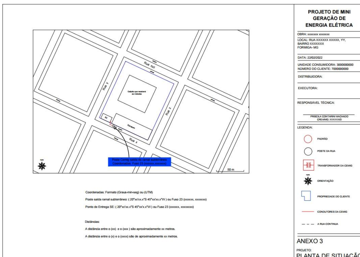
Figura 14 - Planta de Situação.
