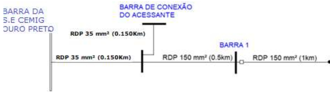
Figura 15: Configuração da rede aérea de distribuição protegida entre barra da SE Cemig e barra do acessante.
