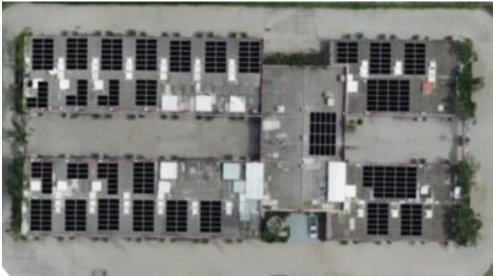
Figura 10: Disposição proposta de módulos FV nos telhados do cliente.
