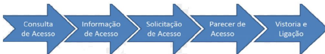
Figura 27: Sequência para conexão de minigeração distribuída.
