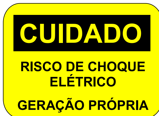
Figura 25: Placa de advertência instalada na usina FV, junto à caixa de medição (medidas 20 x 15 cm).
