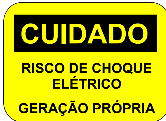
Figura 19: Placa de advertência que deve ser instalada na usina FV, próxima à caixa de medição (medidas 20 x 15 cm).
