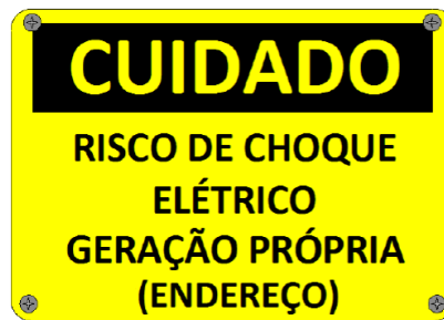
Figura 27: Placa de advertência que deve ser instalada na usina FV, próxima à caixa de medição (medidas 20 x 15 cm).
