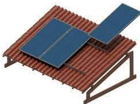
Figura 5: Trilho instalado em um telhado de telhas coloniais.
