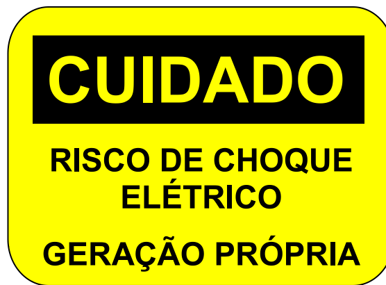
Figura 26: Placa de advertência que deve ser instalada na usina FV, próxima à caixa de medição (medidas 20 x 15 cm).
