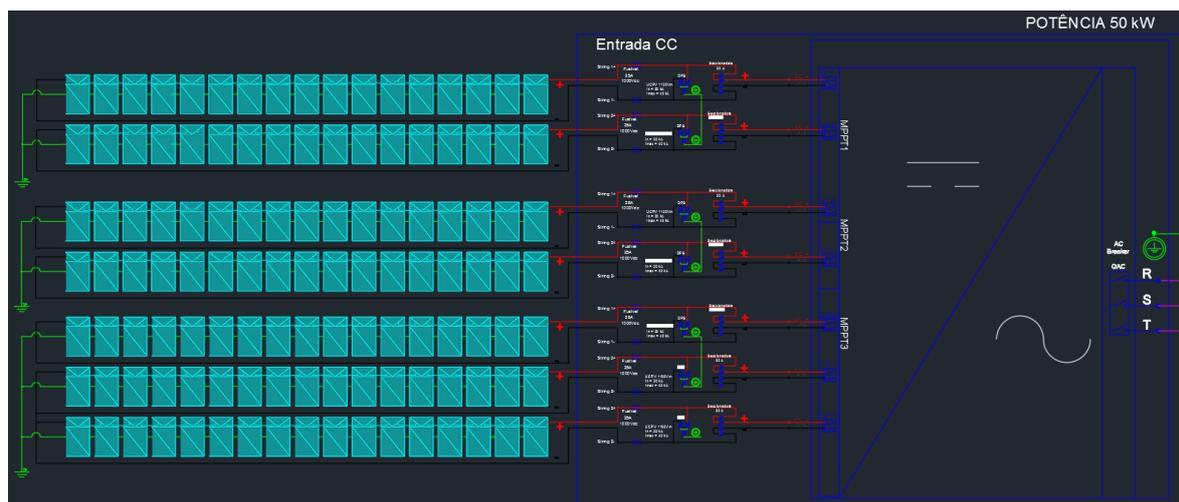
Figura 11: Configuração das séries e arranjo FV conectados ao inversor FV.
