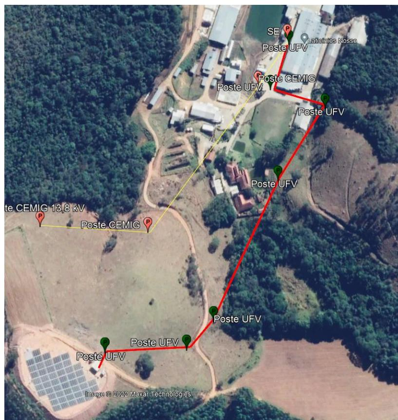
Figura 21: Rota do cabo de alumínio 25 mm<sup>2</sup> até a cabine primária do laticínio.
