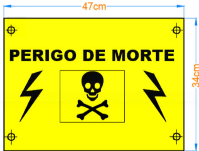
Figura 4. Placa de advertência “PERIGO DE MORTE”.
