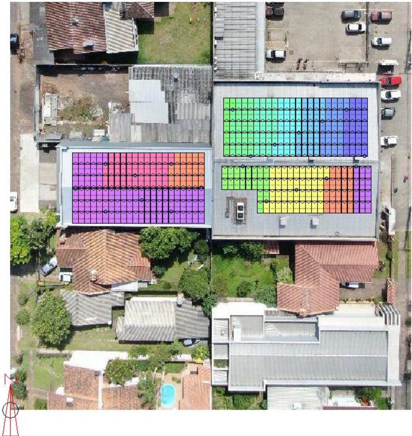
Figura 7: Módulos fotovoltaicos dispostos sobre os telhados.
