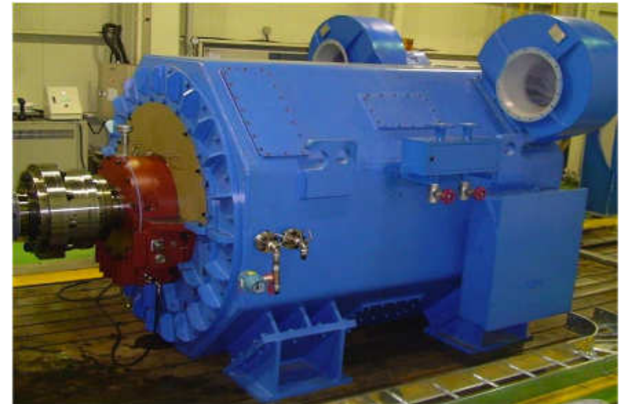
Motor de 5 MW utilizado em propulsão de navios.
