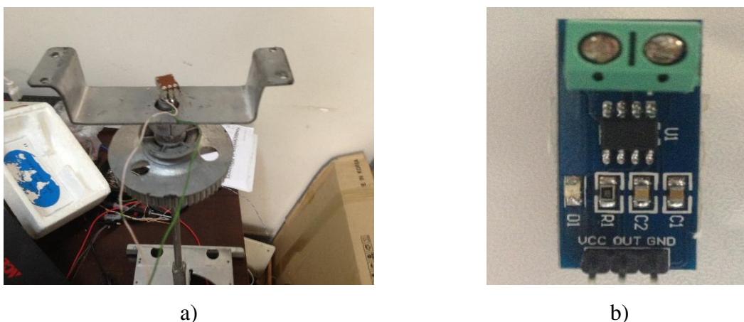
Figura 14 – Sensores. a) Sensor de posição. b) Sensor de corrente.
