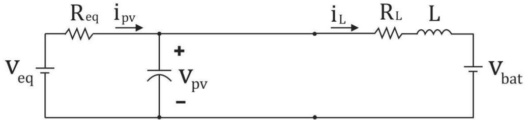
Figura 11 - Circuito equivalente para o dispositivo semiconductor em saturação.
