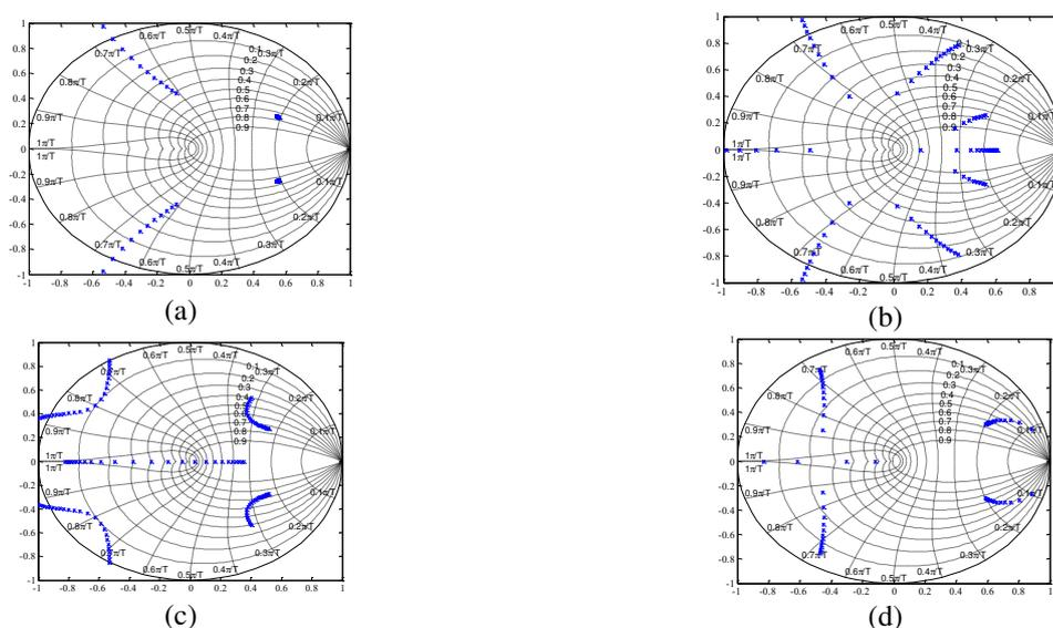
Figura 5 - Local das Raízes no Plano - Z para variação no parâmetro de amortecimento de cada uma das técnicas estudadas. (a) Variação  $R_d$  para AP, (b) Variação de  $K_d$  para RCC, (c) Variação de  $K_d$  para RTC, (d) Variação de  $Q$  para FN.
