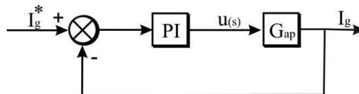
Figura 2 - Diagrama de blocos para técnica de amortecimento por amortecimento passivo
