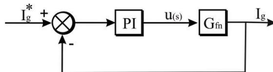
Figura 4 - Diagrama de blocos para técnica de amortecimento por filtro notch
