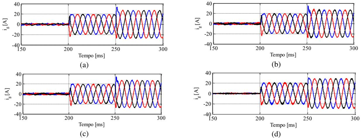
Figura 7 - Comportamento das correntes da rede elétrica em função do tempo para as técnicas de amortecimento apresentadas (a) AP; (b) RCC; (c) RTC; (d) FN
