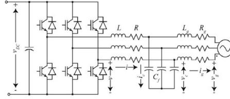
Figura 1 - Inversor trifásico conectado à rede com filtro LCL (Peña-Alzola R. , Liserre, Blaabjerg, & Ordóñez, 2014).
