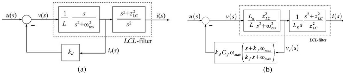
Figura 3 - Estratégias de amortecimento ativo baseadas em realimentação de estados: (a) Realimentação da corrente do capacitor – RCC (Peña-Alzola R. , Liserre, Blaabjerg, & Ordonez, 2014); (b) Realimentação da tensão do capacitor – RTC (Peña-Azola, et al., Systematic Design of the Lead-Lag Network Method for Active Damping in LCL-Filter Based Three Phase Converters, 2014).
