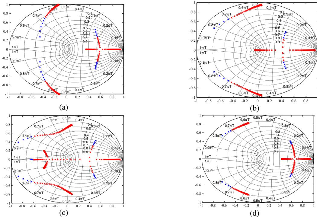
Figura 6 - Variação da Indutância  $L_g$  de 40% até 1000%. (a) AP; (b) RCC; (c) RTC; (d) FN. Os polos em vermelho indicam valores maiores que o nominal e polos em azul indicam valores menores que o nominal.
