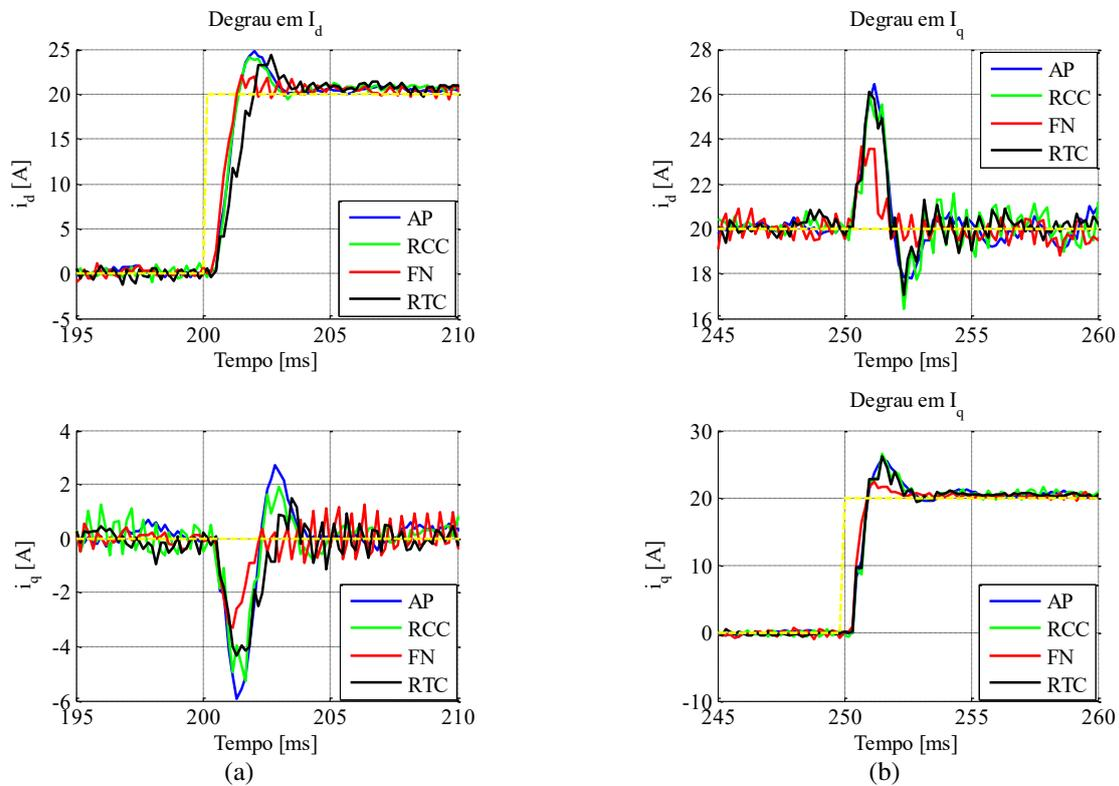
Figura 8 - Dinâmica das componentes de eixo direto e de quadratura da corrente da rede: (a) Degrau na referência de eixo direto; (b) Degrau na referência de eixo de quadratura.
