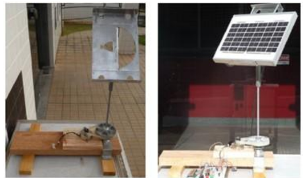
Fig. 5. Estrutura mecânica com motor de acionamento.
